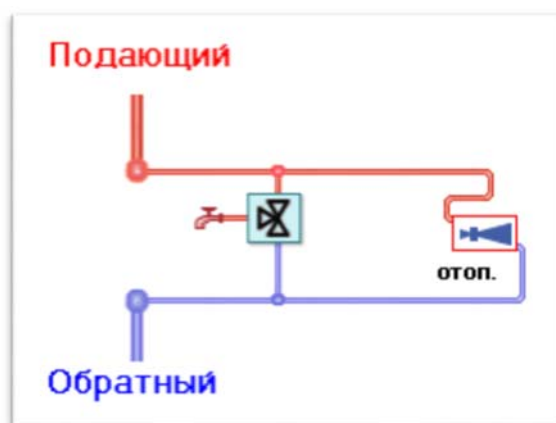
Рисунок 2.1 – Схема 26. Местный тепловой пункт с открытым водоразбором и циркуляционной линией.
